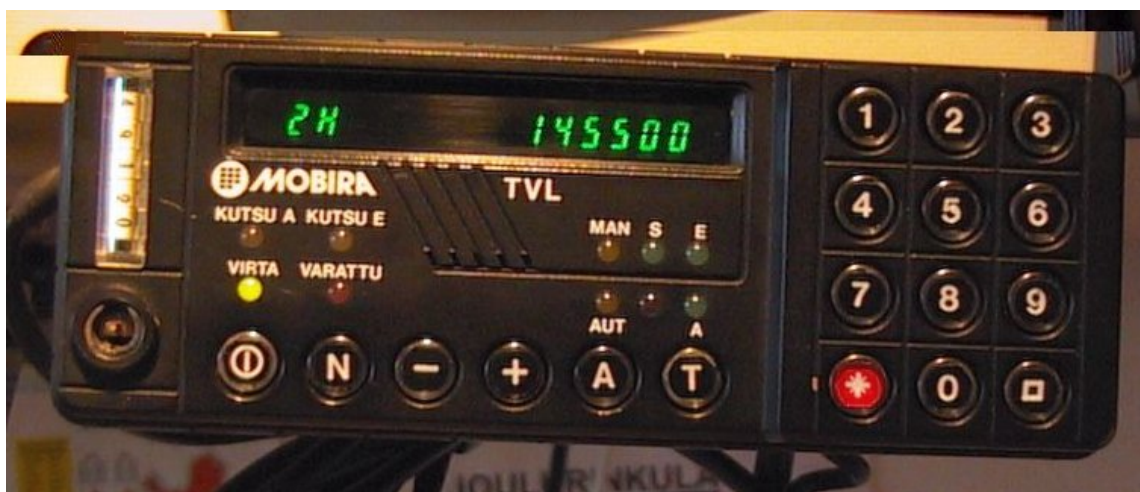
TVL-Mopen käyttölaite. PTL- ja EVH-Mopessa on sama käyttölaite, vain tekstit etupaneelissa vaihtelevat version mukaan.
